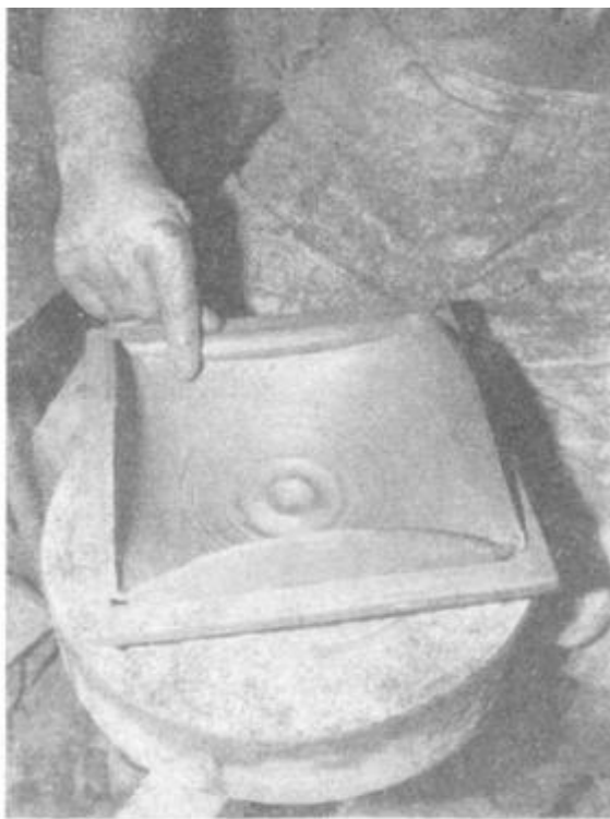
20. ábra A perem visszahajtása ujjal
